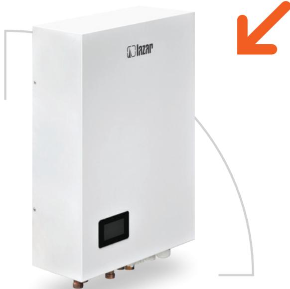
Nell'unità interna **SMART** si trova il controllore che offre molte possibilità all'utente, l'impianto elettrico, il riscaldatore elettrico di supporto, la valvola di commutazione tra riscaldamento centralizzato/acqua calda sanitaria e la pompa di circolazione. È collegata all'unità esterna con il cavo di comunicazione fornito in dotazione.
